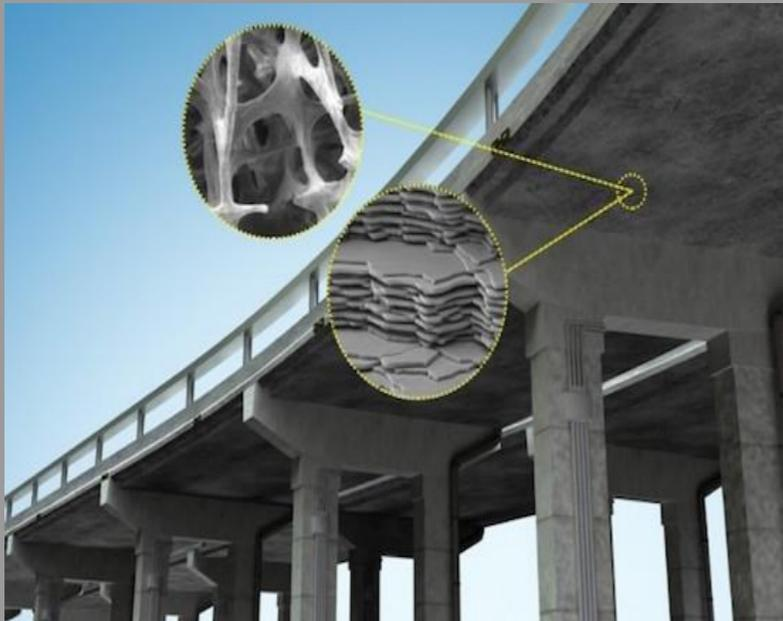
All'interno della pasta di cemento sono inseriti dei batteri dormienti che possono sopravvivere 50 anni senza cibo e ossigeno. Quando si crea una crepa, al contatto con aria o acqua, si riattivano e reagiscono producendo cristalli di calcite che in poche settimane riparano il danno.
